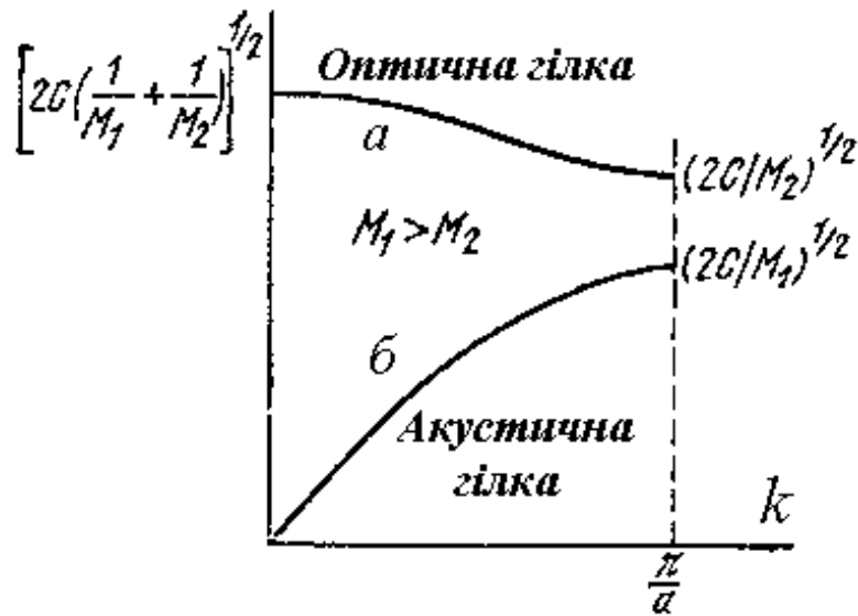
Рис. 2.6. Оптичні (а) та акустичні (б) гілки коливань системи, що має два атоми в елементарній комірни́й ґратці твердого тіла.
